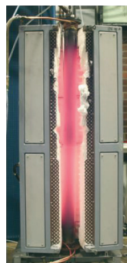
Laboratoriereaktor för förbrännings- och förgasningsförsök
