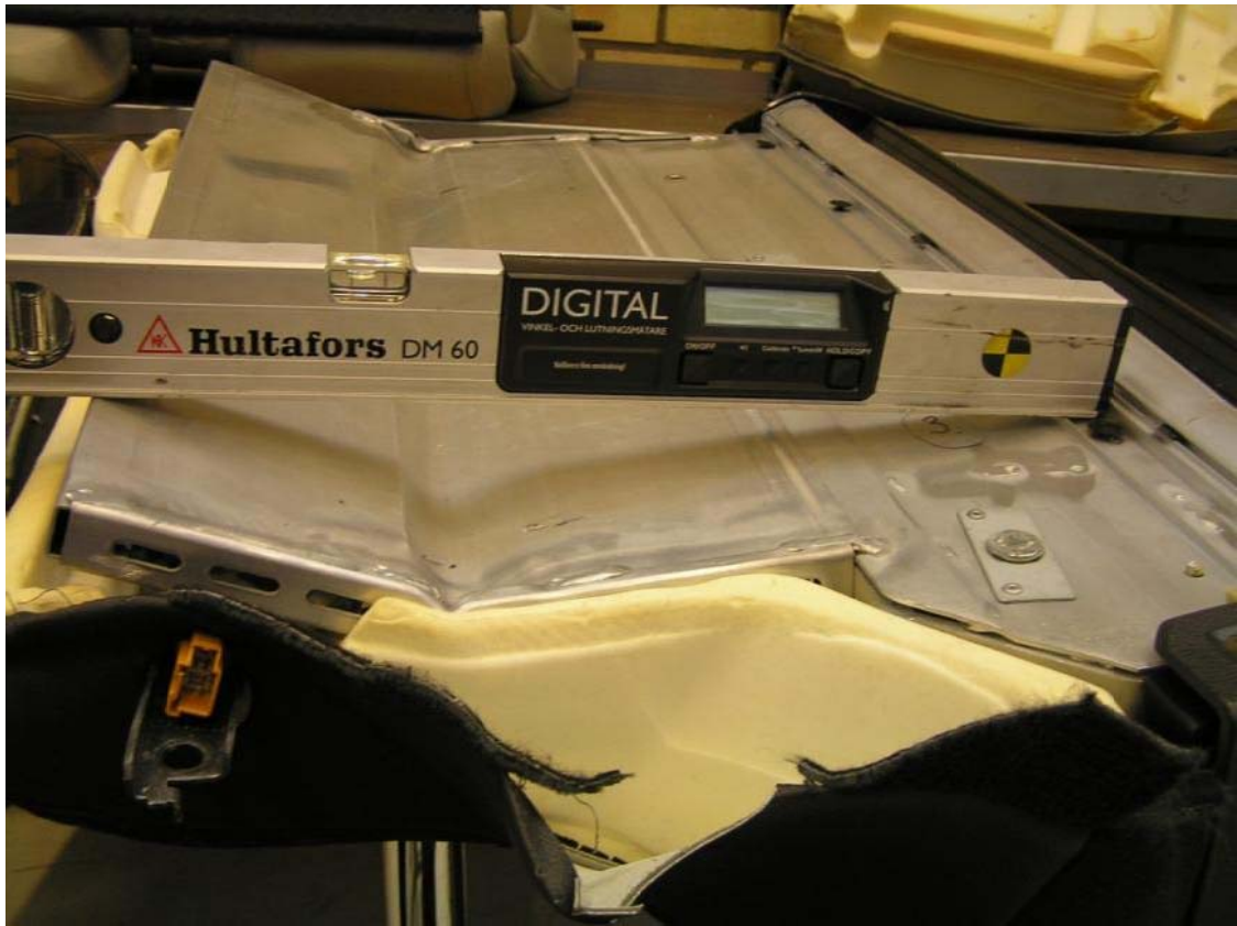
Bild 5, Mätning av den horisontella deformationen av sätesryggen
