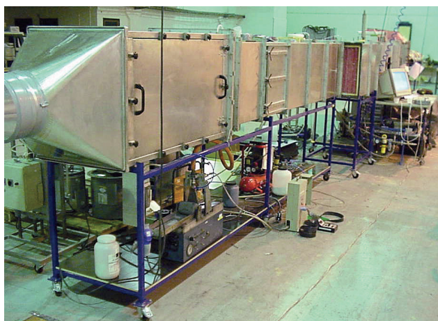
Rigg för laborieprovningar enligt EN 779.
