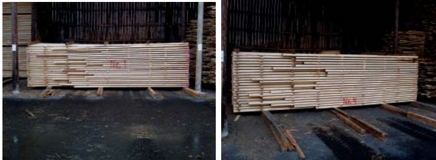
Genom att styra de skevningsbenägna plankorna till bottenpaket kan virke som i det vänstra paketet undvikas.
