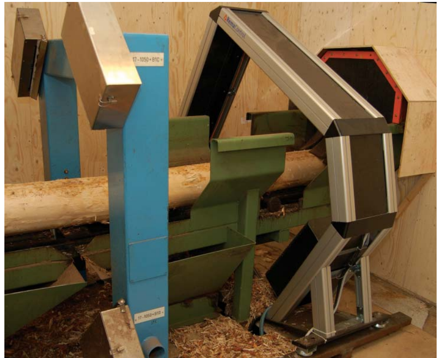
I timmersorteringen på SCAs sågverk i Munksund ger 3D- och röntgenmätningarna detaljerad information om varje stock.
