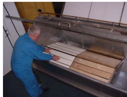
Accelererad provning av väderbeständighet hos brandskyddat trä för bruksklass EXT (=utomhus)
