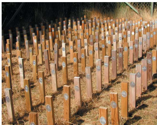
Fältprovning med stavar enligt EN 252.
