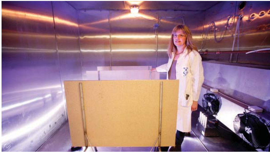
22 m 3 stor emissionskammare för formaldehydmätningar. Gäller som bevismetod i Kalifornien.
