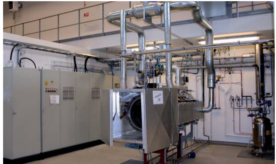
Pilotanläggning för kemisk modifiering genom acetylering.
