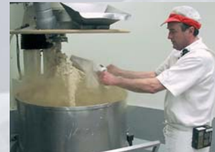
Mätning av damm i inandningszonen hos en bagare.
