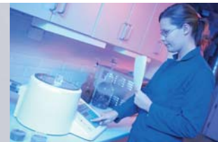
Analys av kornerleksfördelning hos grus med en luftstrålesikt.
