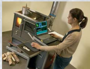
Realtidsmätning av partiklar vid småskalig vedeldning används för att få en ökad förståelse av de transienta förbränningsförloppen.
