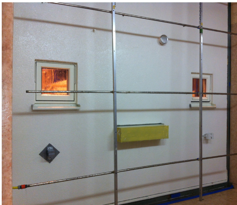
Pågående provning av regntätthet hos putsat fasadsystem med genomföringar och anslutningsdetaljer. Provningsen ska ge svar på om konstruerat system fungerar som tänkt.
