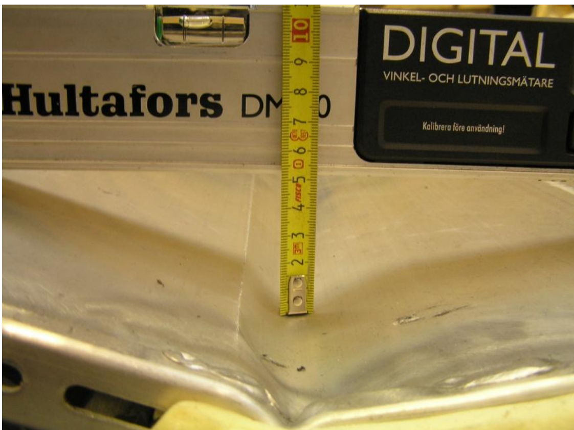
Bild 6, Mätning av den horisontella deformationen av sätesryggen
