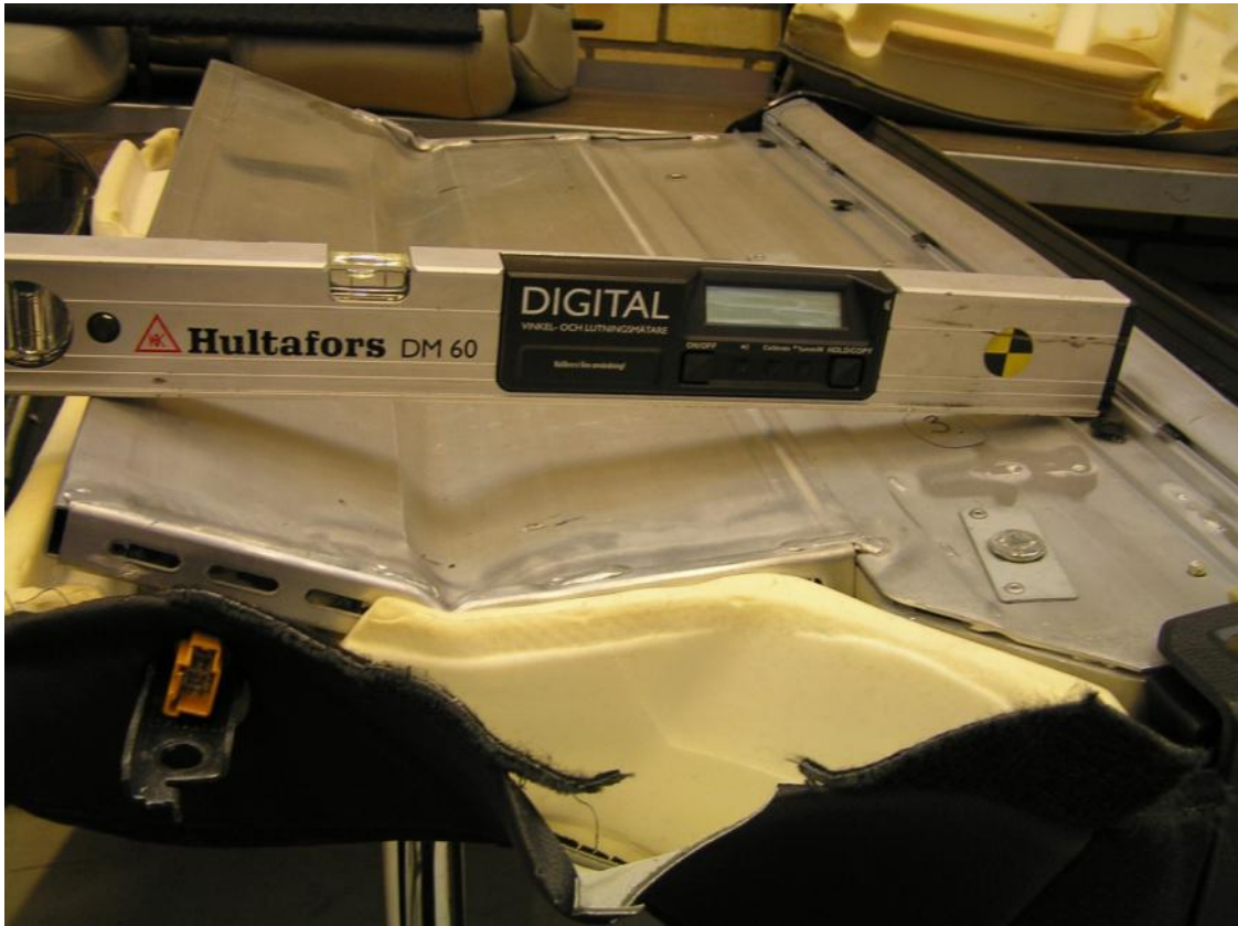
Bild 5, Mätning av den horisontella deformationen av sätesryggen
