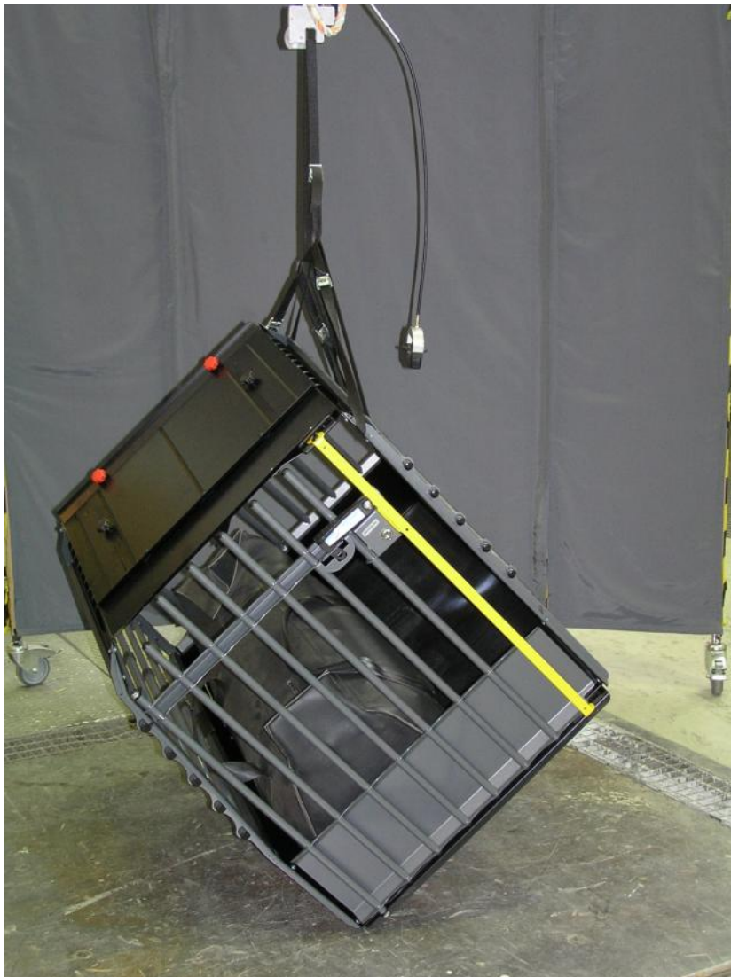
Bild 8, Vinkling av provobjekt innan fallprov
