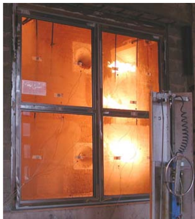
Figur 2. Brandprovning av ett glasat metallparti med en dörr
